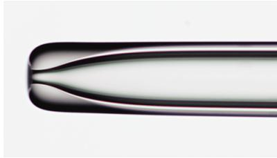
TPC Halterungspipetten haben einen weiten Außendurchmesser von  $120 \pm 10 \mu\text{m}$  und einen proportional weiten Innendurchmesser von  $25 \pm 3 \mu\text{m}$ .
